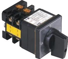
LW15 万能转换开关主要适用于交流 50/60Hz、电流 380V 及以下，直流电压 220V 及以下的电路中转换电气控制线路，也可用于小容量三相交流笼型感应电动机直接控制(起动、可逆转换、变速)。
